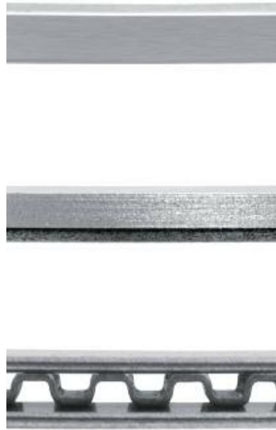
PVD kaplamalı kompresyon segmanı, burunlu açılı kompresyon segmanı ve 3 parçalı yağ sıyrıcı segman içeren segman seti.
